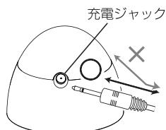
①本体背面にある充電ジャックに、専用充電ケーブルを突き刺すように接続してください。
