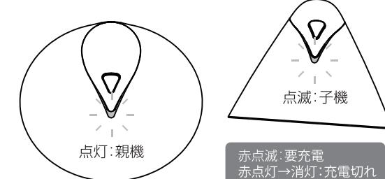
⑤ボタンを押すとモードが変わります。長押し（親機・子機どちらでも）で電源OFFになります。もう一度長押しすると電源ONになります。
