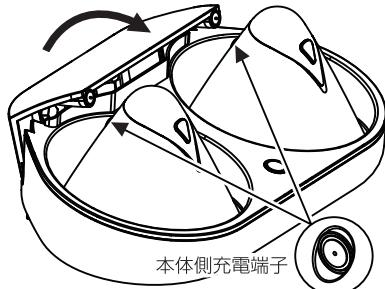
③本体のモードランプが点滅します。ランプが消灯したら充電完了です。2.5時間で満充電となり、60分の連続稼働ができます。
