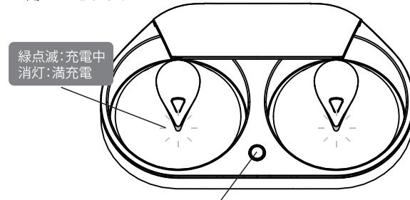
ヒートボタンを長押し（ランプ緑点灯）するとヒーターが本体を加熱します。加熱30分（ランプ緑点灯）+保温30分（ランプ緑点滅）で自動OFF。加熱、保温中の長押しでもOFFになります。
